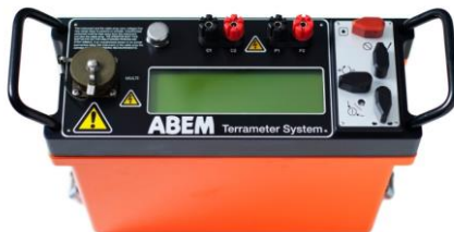
Fig. 4. Instrumentul ABEM Terrameter SAS1000
