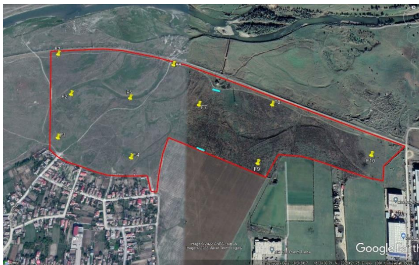
Fig. 4. Amplasarea profilelor geoelectrice (linii de culoare albastră) și a forajelor geotehnice (F1-F10) în teren
